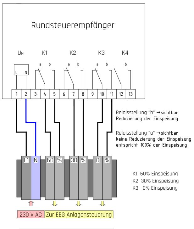
gesicherte und dauernd anstehende Steuerspannung zuführen!
